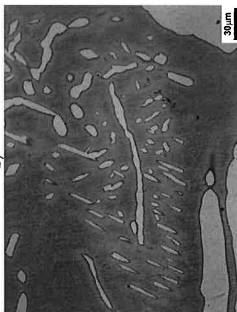
Figura 14 – Microestrutura da amostra PM-1. a) e b) ataque: ácido oxálico 10%, 200x e 500x de aumento, respectivamente; c) e d) ataque: NaOH 25%, 200x e 500x de aumento, respectivamente. As setas indicam a formação de nitretos.
