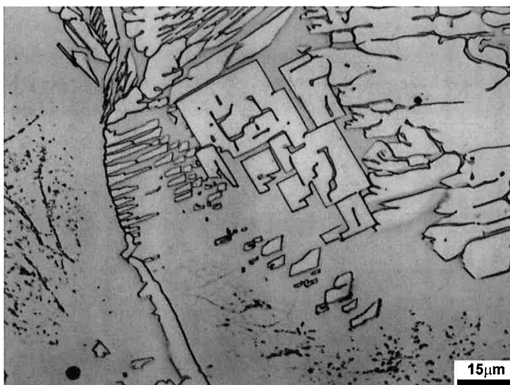
Figura 20 - Amostra CV-3. Ataque: ácido oxálico 10%, 1000x de aumento. Observa-se a formação de flechas e de partículas fechadas de austenita secundária e a precipitação de nitretos na matriz ferrítica.
